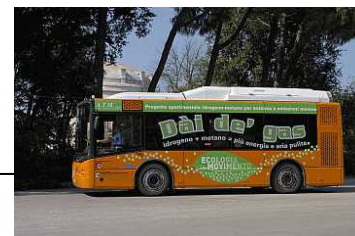
Fig. 22 Autobus a miscela idrogeno-metano
