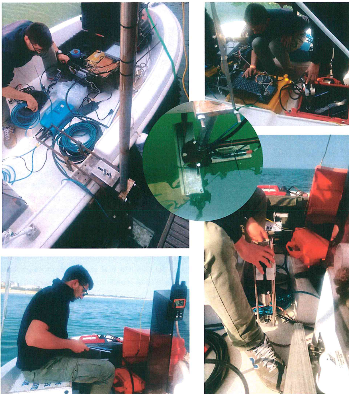
Figura 5– Fasi dell'installazione, calibrazione e rilievo multibeam.
