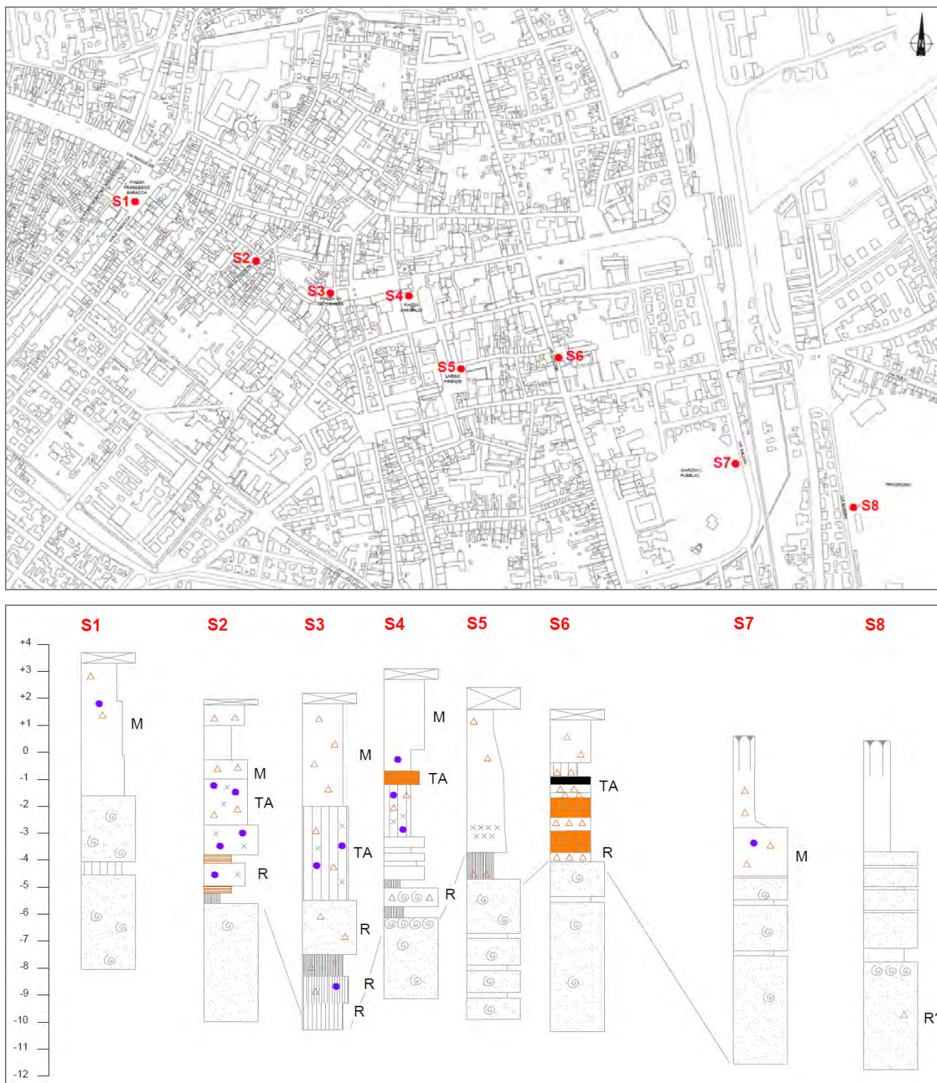
Figura 4 - Localizzazione e sezioni dei sondaggi a carotaggio continuo eseguiti nel centro storico di Ravenna a settembre 2015 (QC 09)
