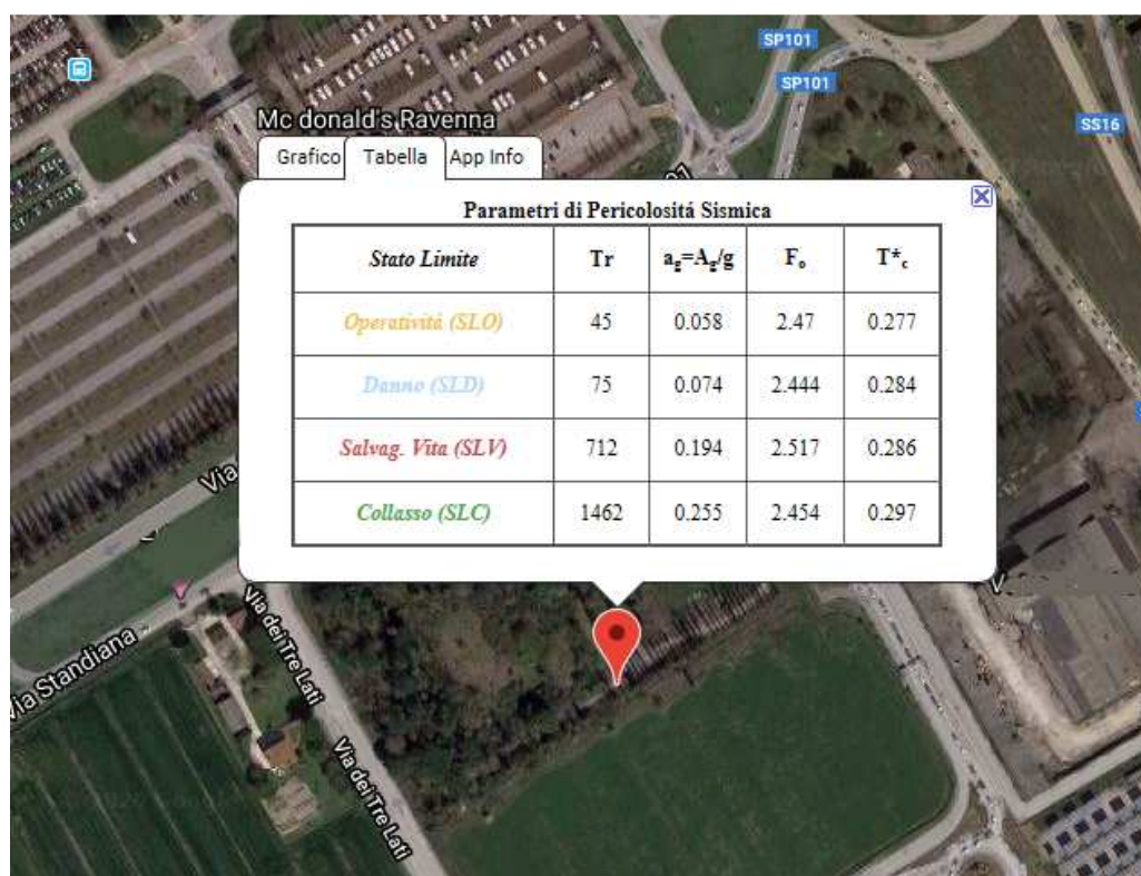
Parametri caratterizzanti lo spettro sismico elastico
