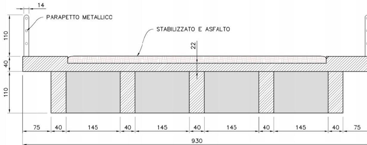
SEZIONE TRASVERSALE DEL NUOVO PONTE
