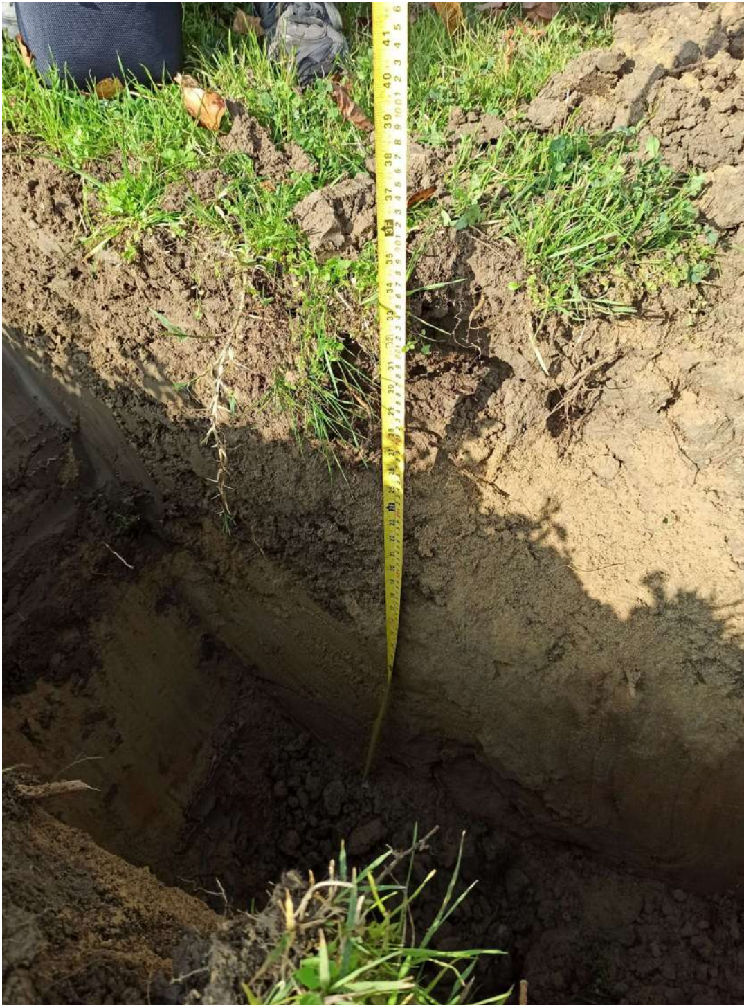
“The Village 2019” Mirabilandia: Saggio di scavo n.2 - prelievo dei campioni di terreno a -0.6m dal p.c.. e risultati delle analisi chimiche
