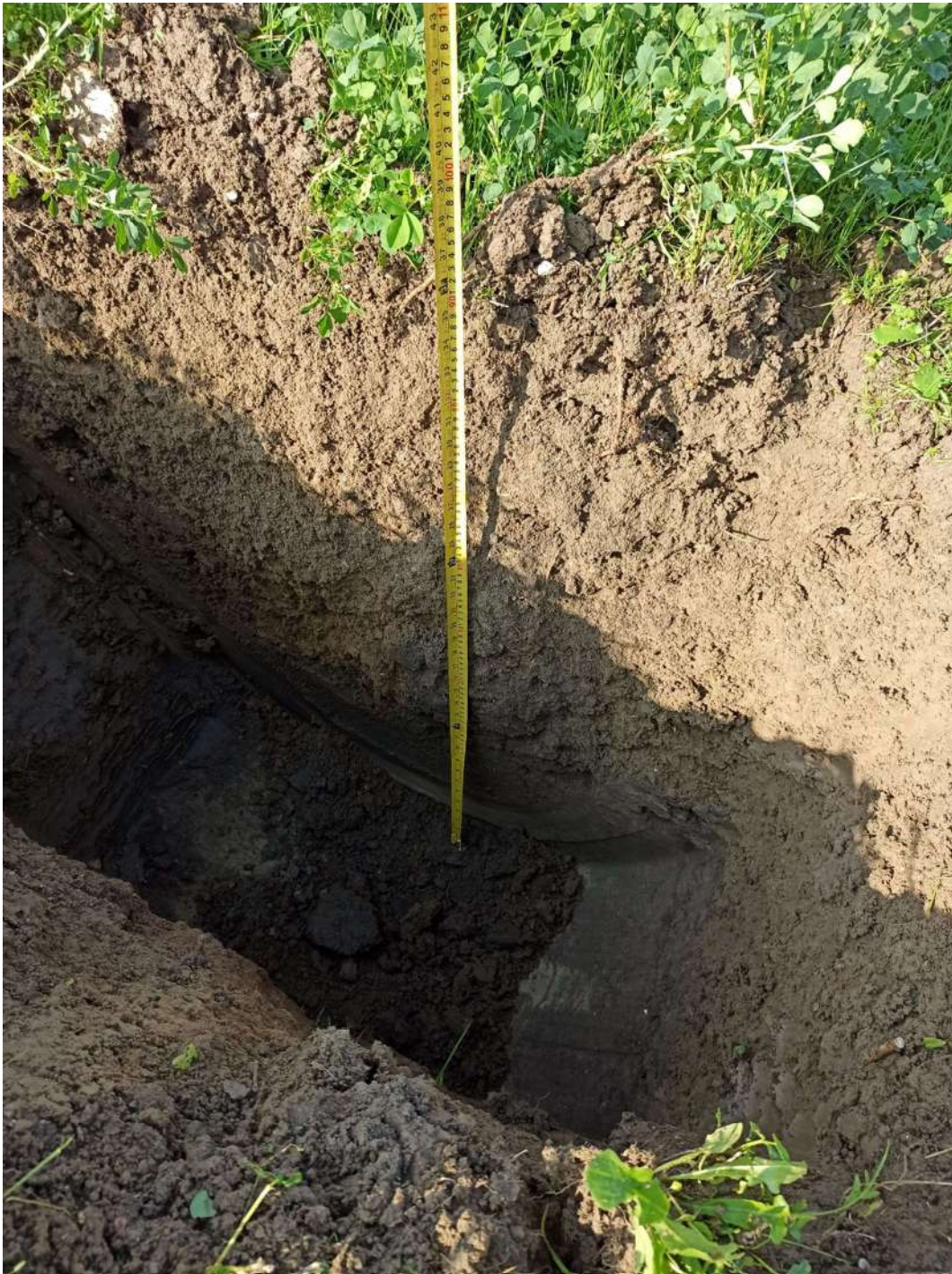
“The Village 2019” Mirabilandia: Saggio di scavo n.3 - prelievo dei campioni di terreno a -0.6m dal p.c.. e risultati delle analisi chimiche
