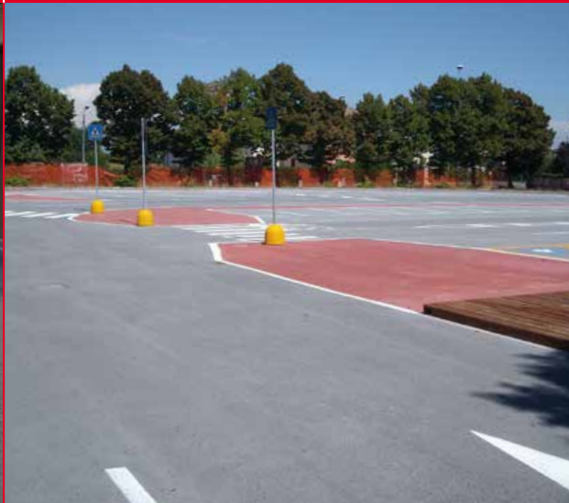
▼ AREA A DIFFERENTI DESTINAZIONI D'USO REALIZZATA CON DIVERSE PIGMENTAZIONI DI DRAINBETON®
