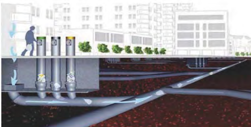
Esempio di raccolta pneumatica rifiuti
