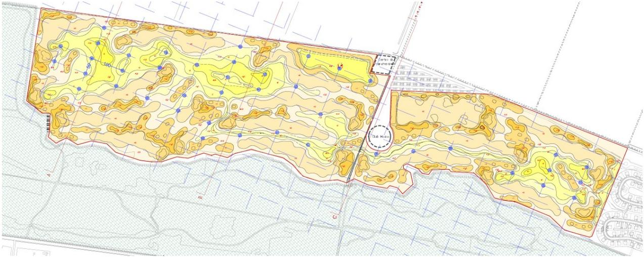
In corrispondenza di ciascun punto individuato in planimetria, si prevede il prelievo 2 o 3 campioni (uno nel primo ed uno nel fondo scavo ed eventualmente uno intermedio in base alla profondità di scavo) mediante sondaggio a carotaggio con coclea.
