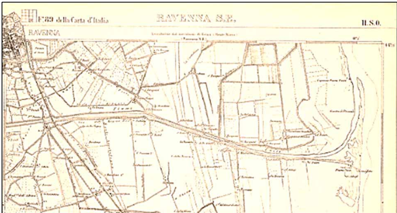
Fig. 46 – Evidente su questa carta topografica IGM del 1911 lo sviluppo della falciatura sabbiosa (freccia litoranea o spit) diretta verso nord che all'epoca si registrava anche alla foce di F.mi Uniti, oltre che in corrispondenza di altre foci della zona. Struttura smantellatasi poi abbastanza rapidamente e negli ultimi decenni presente solo alla foce del T. Bevano per il costante, seppur modesto, apporto di sabbia erosa a sud.
