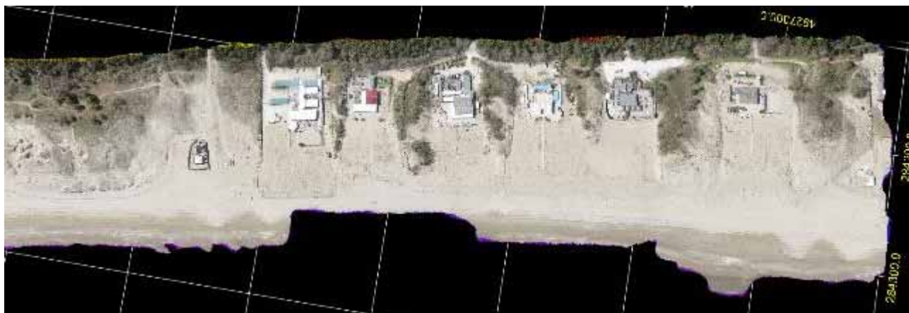
Figura 64- Esempio di rilievo ad alta risoluzione ( 5 cm nell’altimetrico) delle strutture costiere, sia naturali effettuato nei primi mesi del 2015 via drone.
