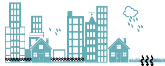
2012 30%-40% di sup. urbanizzata sistemi di drenaggio urbano tradizionali, allagamenti di porzioni di città, infiltrazione in aree inedificate sempre meno estese
