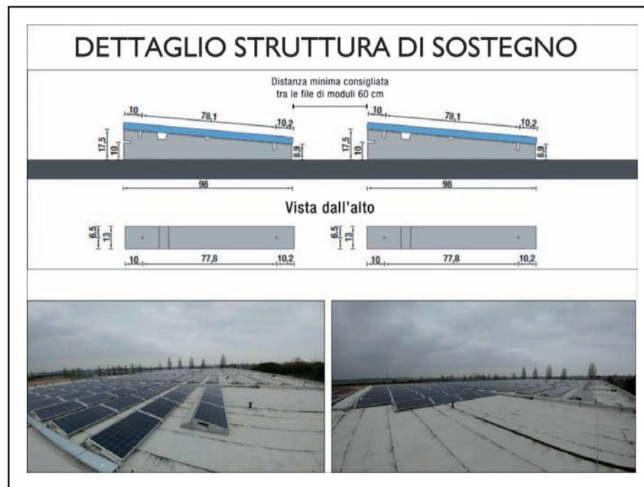
I pannelli verranno inseriti all'interno delle strutture di copertura, in modo tale da incidere minimamente sull'impatto visivo.
