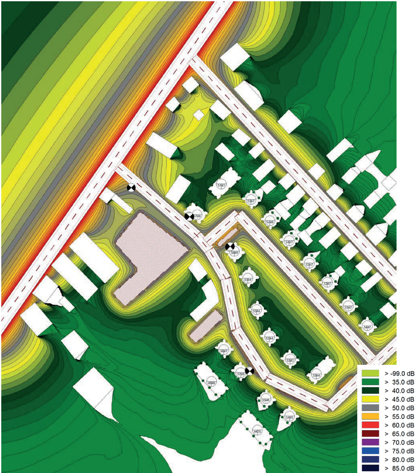
Figura 12: Mappa delle superfici di isolivello sonoro in periodo notturno ad altezza 1,5 m – stato di progetto
