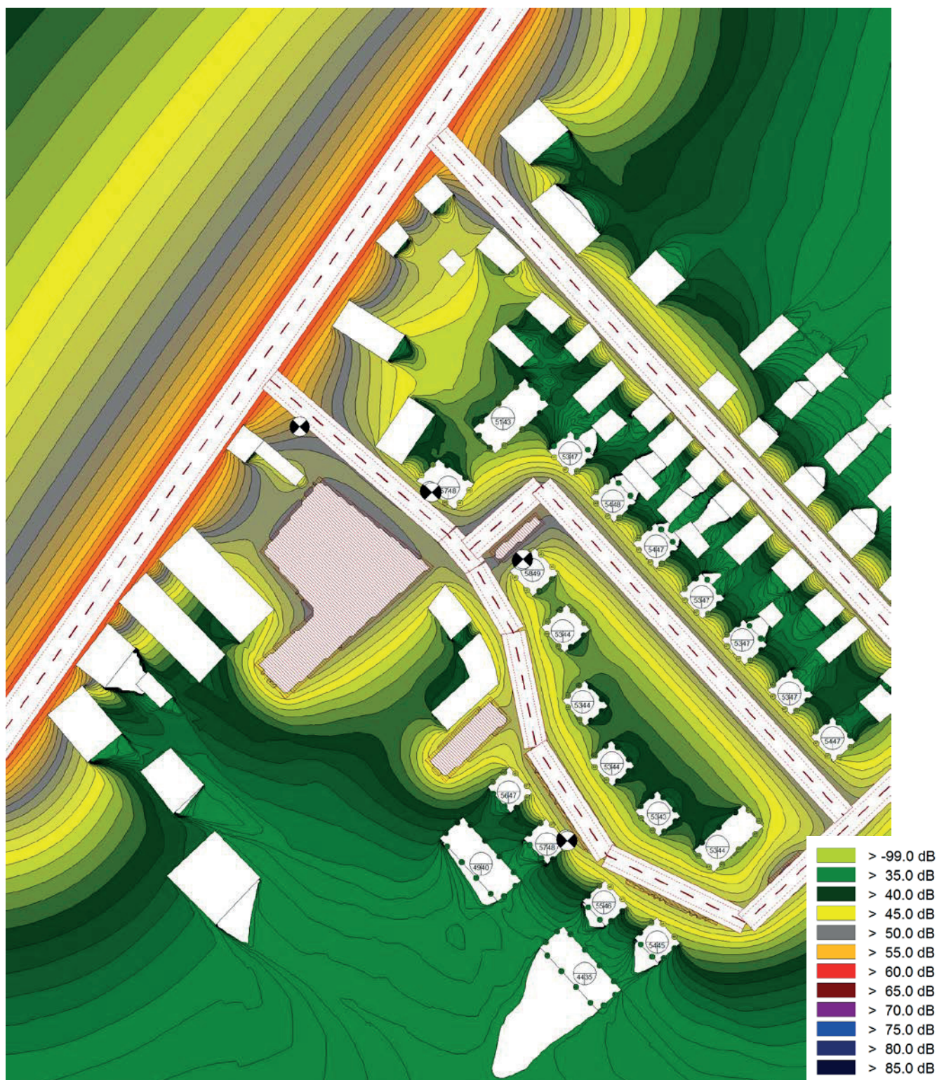
Figura 13: Mappa delle superfici di isolivello sonoro in periodo notturno ad altezza 4,5 m – stato di progetto
